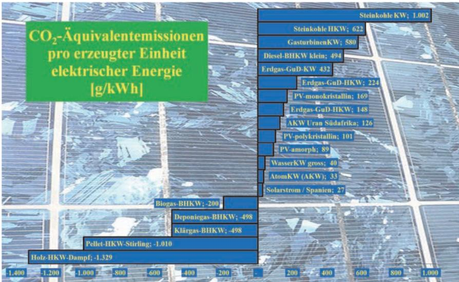
Abbildung 2: Kohlenstoffintensität verschiedener Brennstoffe; Abkürzungen: KW - Kraftwerk, HKW - Heizkraftwerk, BHKW - Blockheizkraftwerk, PV - Photovoltaik; Daten aus: [6], [44], [44a]; Diagramm: [105]
